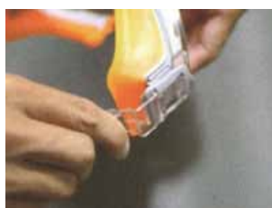
3. 鏡腳勾入鏡架後，順勢 向外扳開
